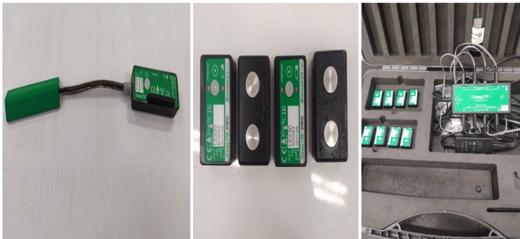
شکل (۲): ۱-دستگاه الکترومایوگرافی مورد استفاده در پژوهش، ۲- نمونه‌ای از الکترودهای استفاده شده، ۳- گونیامتر الکتریکی
