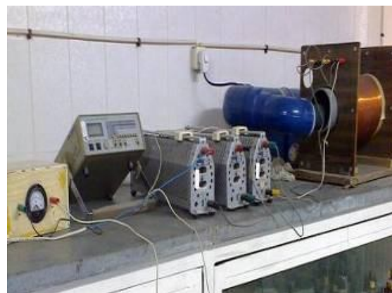
شکل (۱): سیستم مولد میدان الکترومغناطیس و انکوباسیون به ترتیب از راست به چپ شامل: سیم پیچ مولد میدان الکترومغناطیسی، سیستم انکوباسیون، رئوستا، آمپر متر، خازن
