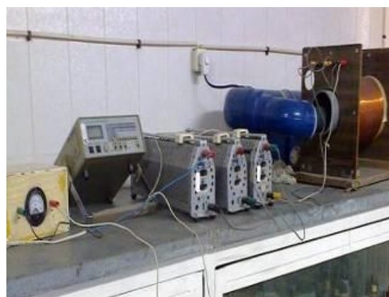
شکل (۱): سیستم مولد میدان الکترومغناطیس و انکوباسیون به ترتیب از راست به چپ شامل: سیم پیچ مولد میدان الکترومغناطیسی، سیستم انکوباسیون، رئوستا، آمپر متر، خازن
