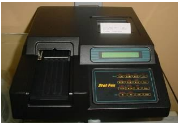
شکل (۲): Elisa reader (Stat Fax 303 Plus) جهت سنجش تست MTT
