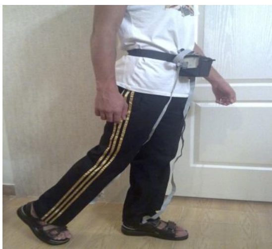
شکل الف: نمایش نحوه پوشیدن و اتصال ابزار اندازه گیری
